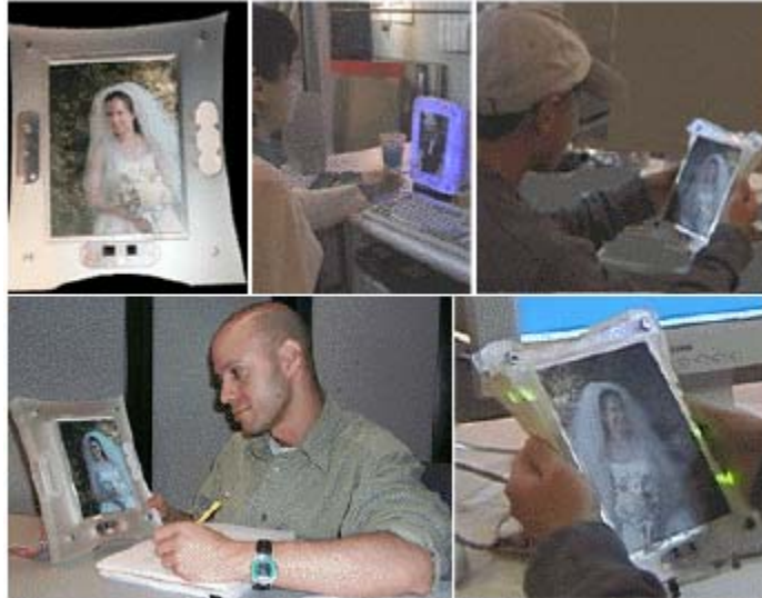
Abb. 3. (Im Uhrzeigersinn, Start links oben) Ein nicht aktiver LumiTouch; ein User, passive Interaktion mit dem LumiTouch; die Rückmeldung des Rahmens auf eine Benutzereingabe im oberen Leuchtbereich; die Anzeige leuchtet, wenn eine Nachricht empfangen wird; ein Benutzer der aktiv mit dem LumiTouch interagiert [5].
