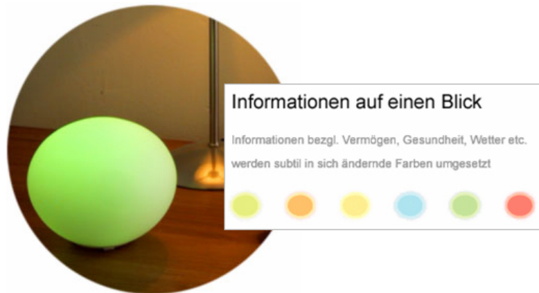
Fig. 6. Ambient Orb. Das leuchtende Ei erzeugt je nach verknüpfter Information verschiedene Farbschattierungen. Copyright by Ambient Devices [9]
